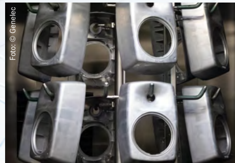
Die Lautsprechergehäuse bestehen aus recyceltem Aluminium
