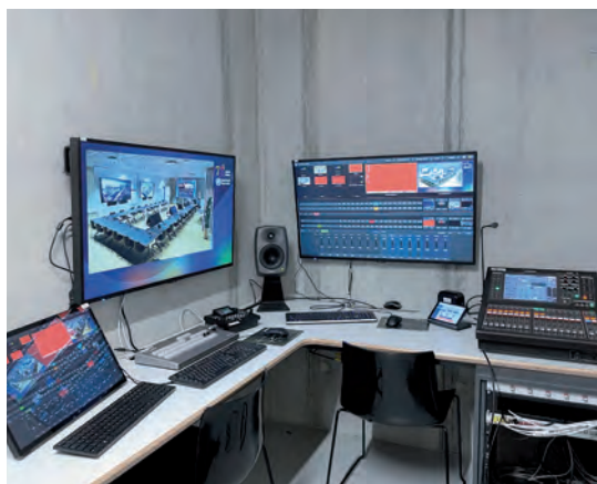
In zwei der vier Räumen besteht die Möglichkeit zu einer Videokonferenz mit Cisco Codec Pro – gesteuert über ein Cisco Touchpanel und ein Touchpanel von Crestron.
